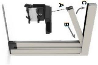
**7** Infilamento profilo di chiusura con piallina
